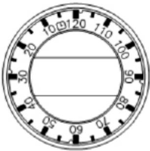
Die Herde sind mit einem akustischen Timer ausgestattet, der eine maximale Zeit von 120 Minuten anzeigen kann. Drehen Sie den Knopf nach rechts und stellen Sie ihn auf die voreingestellte Zeit zwischen 0 und 120 Minuten (siehe Abbildung); Wenn die eingestellte Zeit abgelaufen ist, wird der akustische Timer aktiviert.
